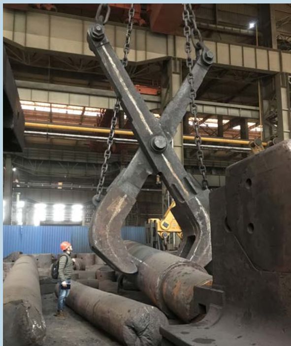
左: 埃塞基尔·卡列特在中国中信建设集团 (CITIC) 的工厂查看锻造涡轮轴。
